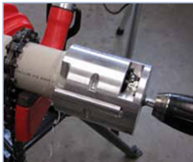
Skrap utsiden av røret.
