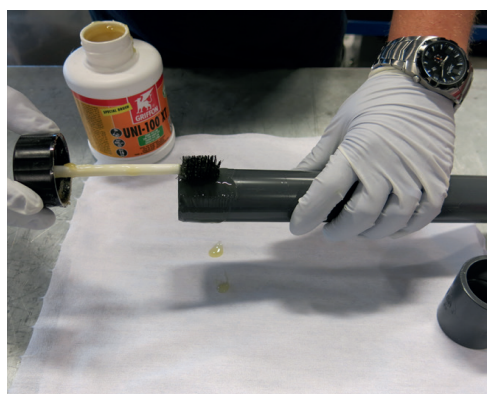
Lim på med pensel i lengderetning. Legg et tykt lag med lim på røret, og et tynt et i muffen.
