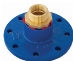
S-9660-2 Blindflens med Esco Lock bajonettkobling i avsinkningsfri messing. Med 2 " utvendig og 1 1/2 " innvendige rørgjenger
