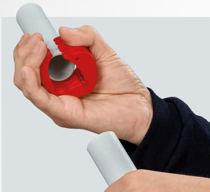
Praktisk, rask og ren: plastrørene kan kuttes raskt og delene er sikret i verktøyet.
