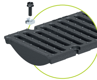
6 SPALTERIST I STØPEJERN spaltebredde 14/150 klasse F 900 *4. punkts bolting er mulig kun til renner støpejernsramme.
