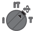
Läge Vario-Lock för inställning av mejselläget I detta läge snäpper inte slag-/vridstoppssomkopplaren 13 fast.
