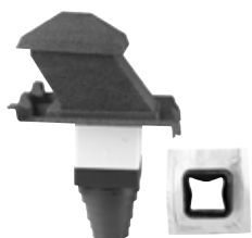
Luftehatt 10°-45° Nobb: 53640557 Inkl. gummimansjett med selvklebende butylkrage. 1 stk. pr. pakke.
