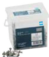
BMI skruer Nobb: 48783923 5,0 x 35 mm. Forbruk: 10 stk. pr. m². Stålkvalitet AISI 410. 500 stk. pr. boks.
