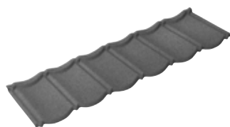
Galba takpanne Nobb: 53640606 Dekkende mål: 369 x 1260 mm. 2,15 panner pr. m². 320 stk. pr. pall.
