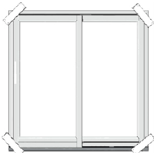
Fig. 4: Sikkerhetsklosser monteres på utsiden før døren settes inn.
