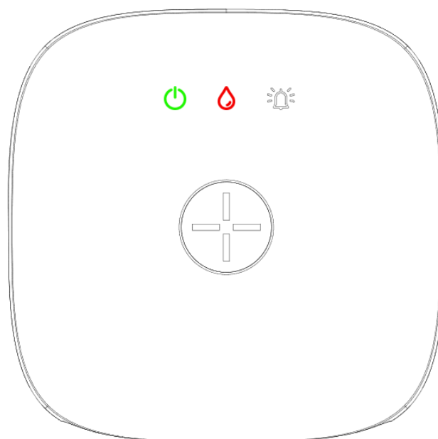
Ventilen er stengt
