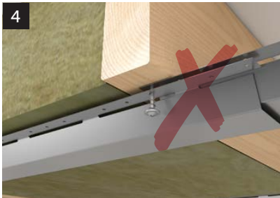
4 Profilene skal ikke overlappes ved skjøting.
