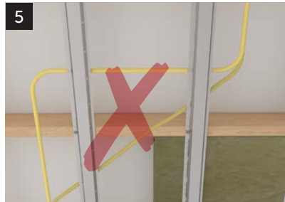
5 El- og vvs-rør skal monteres parallelt eller vinkelrett mot profilen og må ikke komme i klem mellom bjelke og profil.
