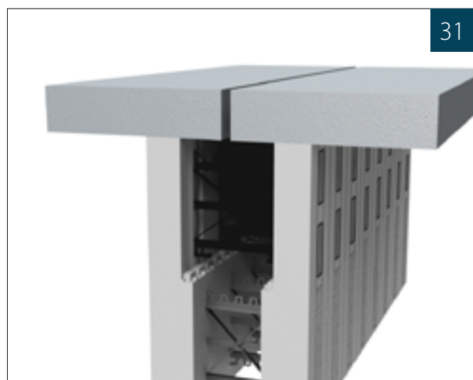
Fig. 31: Toppblokk av Thermomur® 350HD kan brukes som "kroneblokk" på toppen av en vanlig 350-mur dersom det trengs ekstra betongbredde til skjøting av hulldekker.
