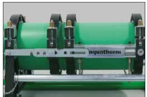
Trekk sammen rørene. La kjøle under trykk
