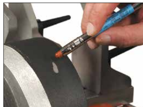
Temperaturkontroll med temperaturpenn
