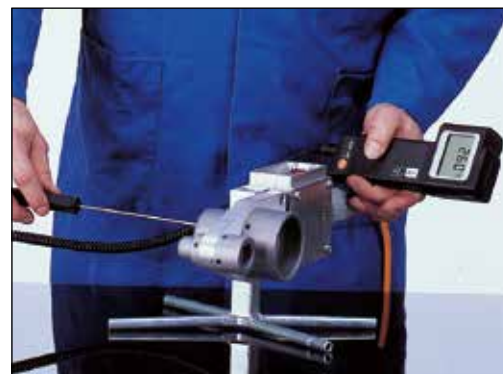
Temperaturkontroll med måleinstrument
