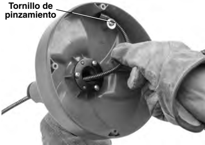
Figura 11 – Fijación del extremo del cable
