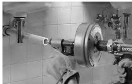
Figure 7 – Exemple de prolongation de la canalisation à moins de 4" (10 cm) du point d'entrée
