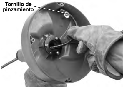
Figura 11 – Fijación del extremo del cable
