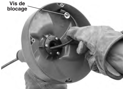
Figure 11 – Amarrage de l'extrémité du câble
