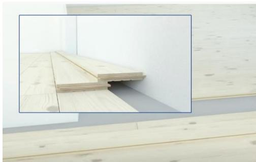
Rør: Mål ut plasseringen på gulvbordet og bør hull som er 10 mm større enn røret. Sag på skrå inn mot hullet. Monter gulvbordet, og lim deretter på plass biten som er sagd ut. Alle avstandsklosser og kiler må fjernes før man legger ny vegglist.
