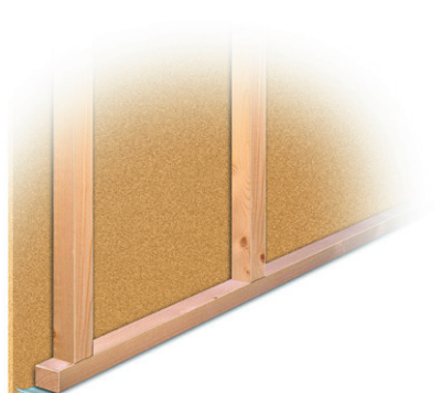
EI 15. Vegg med stomme av träreglar min. 45x45 mm c ≤600 mm, på en sida försedd med min. Byggelits 12 mm spånskivor.
