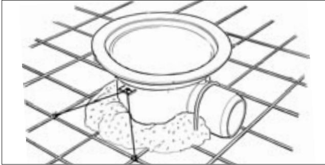
Sluket bindes til armeringen
