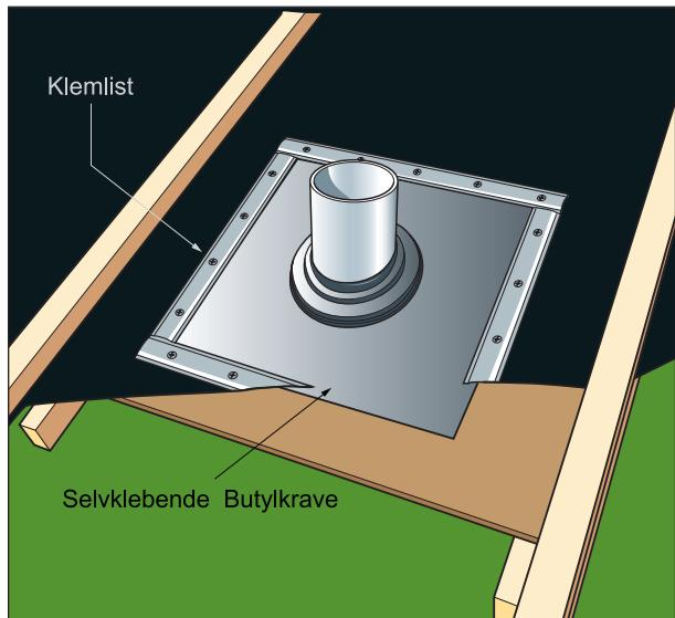
Tekk inn røret mot undertaket med mansjetten med selvklebende butylkrave.
