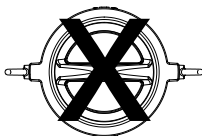
Feil orientering for horisontal installasjon
