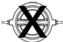
Feil orientering for horisontal installasjon
