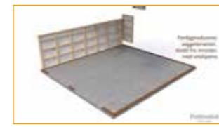
Bygg sammen veggelementene
