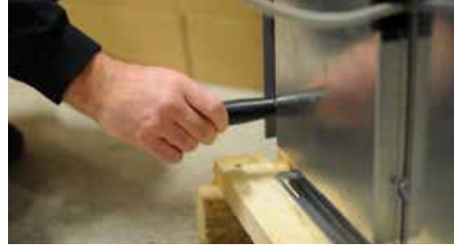
2. Fest de to bærehåndtakene i kjølemodulens nerkant.
