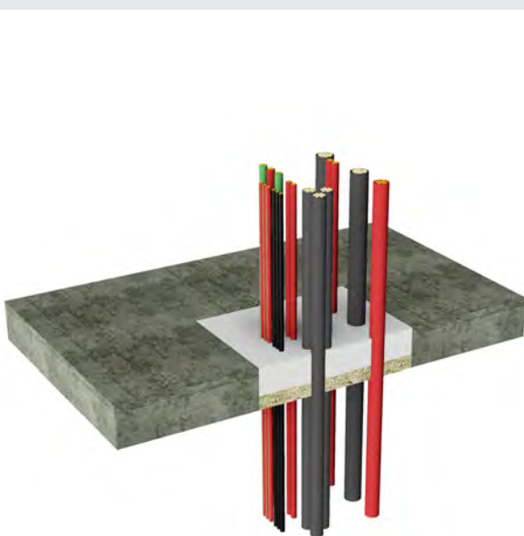
Figur 7. Tykkelse: 100 mm GPG og 50 mm steinull
