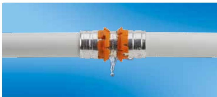
3. Test De manglende stoppringene indikerer en pålitelig og riktig utført kobling. Det er visuelt kontrollerbart på mange meters avstand.
