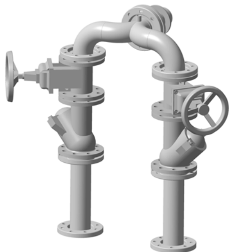
Fig. 5 DC, rørsystem med direkte afgang
