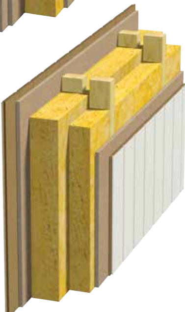
Fig. 4 Innvendig vegg. Dobbel heltre stender. To platelag.
