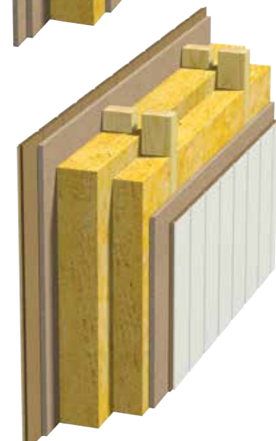
Fig. 4 Innvendig vegg. Dobbel heltre stender. To platelag.
