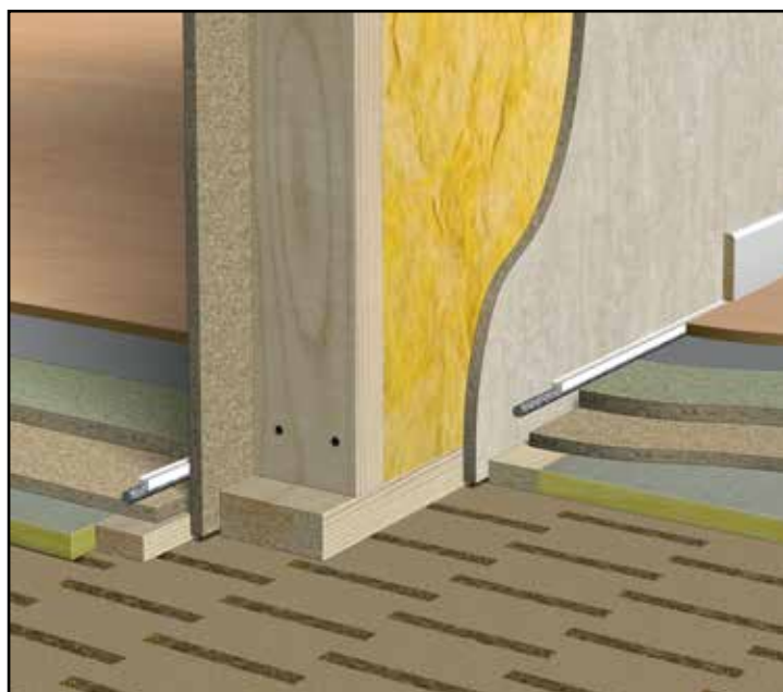
Gulv, mot innervegg
