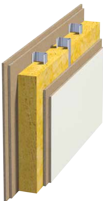
Fig. 6 Innvendig vegg. Forskjøvet stålstender med to platalag
