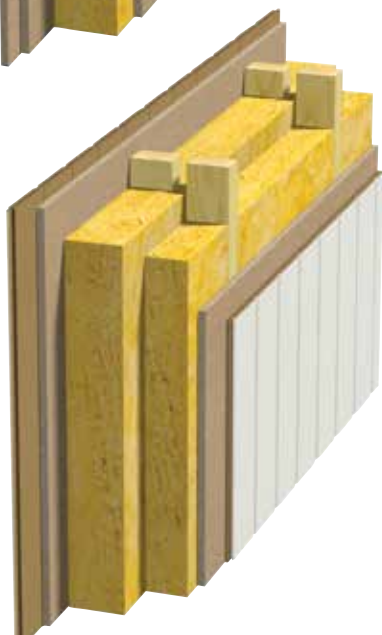
Fig. 4 Innvendig vegg. Dobbel heltre stender. To platelag.
