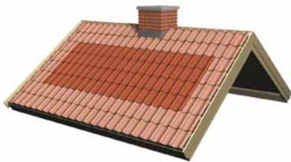
Bilde 15. Randsoner skall alltid festes. Det er 10% av takets lengde på hver side og 20% av takets bredde, både oppe og nede. Bratte tak og værutsatte steder kan kreve mere innfestning. Konferer lokale regler eller NBI blad "Tekking med takstein: materialer, legging og forankring". Byggdetaljer 544.101 - del 1 og 2.
