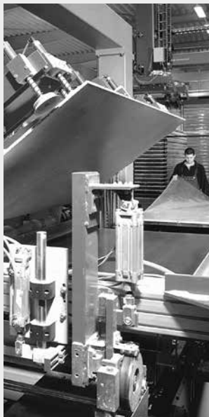
Fulldautomatisk udtagning af pladerne af formene.
