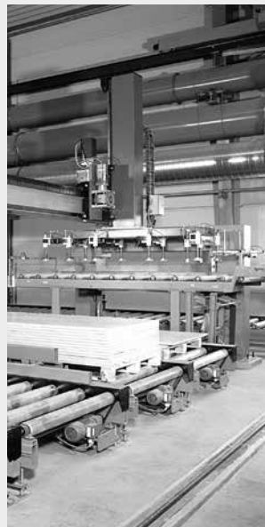
Stabling af pladerne på paller.
