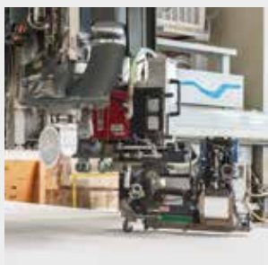
Klammebro til maskinel befæstigelse.
