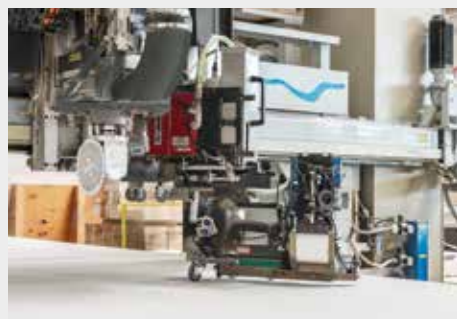
Klammebro til maskinel befæstigelse.
