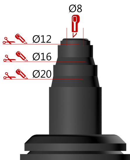
Kapping av rørgjennomføring
