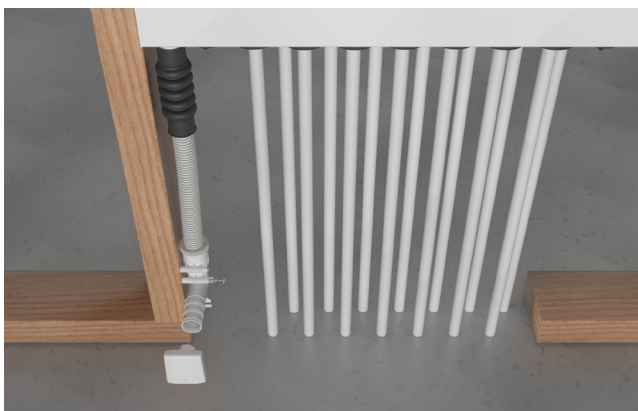
Dreneringsbend tilkoblet via varerør
