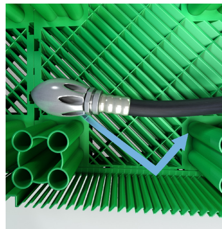
Den smarte konstruksjonen i sideplater og bunnplater – skrå ribber – sprer vannstrålen under høytrykksspyling og forhindrer skader på geotekstilene eller membran
