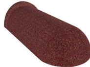
Valmbegynnelse Dimensjon: 100x190x425 mm Dekkende mål: 400 mm 20 stk./boks 0,75 kg/stk. 15 kg/boks
