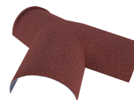
Valmklokke 15-30° Dimensjon: 130x485x485 mm 5 stk./boks 0,73 kg/stk. 4,3 kg/boks
