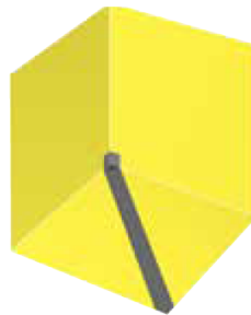
7. Forsegl med GLAVA® Radontape
