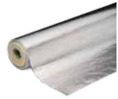
PAROC REPARASJONSFOLIE Armert aluminiumsfolie, belagt med PE på baksiden. For reparasjon av AluCoat-produkter. Varmes på med strykejern.
