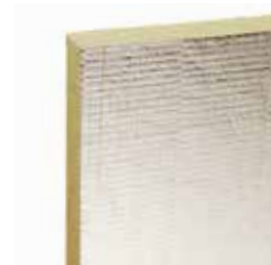
PAROC HVAC SLAB ALUCOAT Ikke-brennbar plate av steinull med overflatelag av armert aluminiumsfolie, tilpasset for kondens-, lyd- og varmeisolering.
