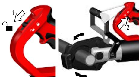
3. Lorsque la coupe est terminée, tirer le déclencheur de réarmement pour ouvrir les lames. (3)
