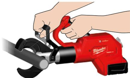
2. Agarre a(s) pega(s) com firmeza. Mova a corredeira para a posição desbloqueada. (1) Puxe e segure o gatilho durante toda a operação. (2) Quando o gatilho é puxado, acende-se um LED. Quando o corte estiver concluído ou a ferramenta se desligar, solte o gatilho.
