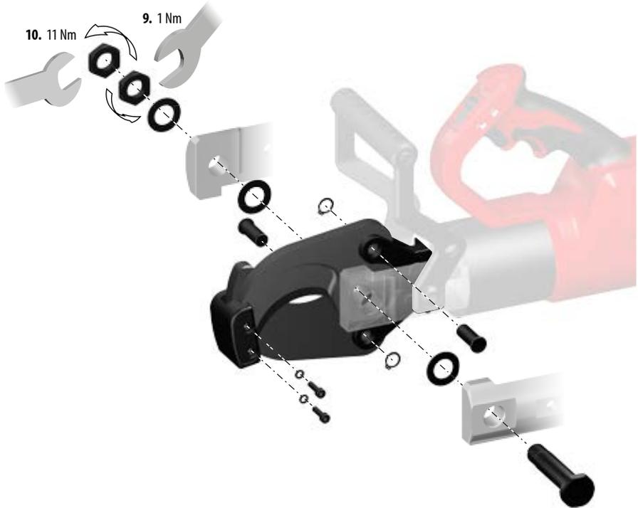
1. Verwenden Sie einen Schraubenschlüssel oder eine Zange, um die Klingennuttern sowie die Klingenschrauben zu entfernen.
