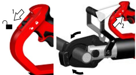
3. Wenn der Schnitt durchgeführt ist, betätigen Sie den Rückstellschalter, damit sich die Schneidbacken öffnen. (3)
