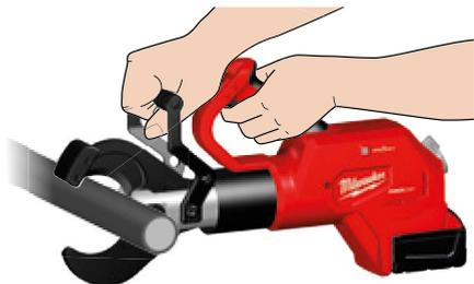
2. Крепко возьмитесь за рукоятки. Переведите ползунковый переключатель в положение разблокировки. (1) Нажмите и удерживайте курок во время работы. (2) При нажатии пускового курка загорается светодиодный индикатор. После завершения разрезания или после выключения инструмента отпустите пусковой курок.
