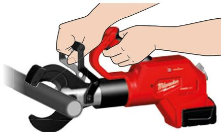
2. Apucați ferm mânerul(ele). Deplasați comutatorul glisant pe poziția deblocat. (1) Trageți și mențineți tras declanșatorul în timpul utilizării. (2) Atunci când declanșatorul este tras se aprinde un LED. După ce tăierea este finalizată sau dispozitivul se deconectează, eliberați declanșatorul.
