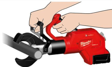
2. Grijp de handgreep of handgrepen stevig vast. Zet de schuifschakelaar in ontgrendelde positie. (1) Duw de hendel in en houd deze vast gedurende de gehele operatie. (2) Er licht een ledlampje op wanneer de hendel wordt ingedrukt. Als het knippen is voltooid en het gereedschap uitschakelt, laat u de hendel los.
