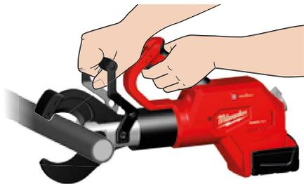
2. Stingri satveriet rokturi(-us). Pārvietojiet bīdāmo slēdzi atbloķētā stāvoklī. (1) Nospiediet mēlīti un visu operācijas laiku turiet to nospiestu. (2) Piespiežot mēlīti, iedegas gaismas diode. Kad griešana pabeigta vai instruments izslēdzas, atlaidiet mēlīti.
