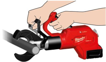
2. Čvrsto držite ručku/e. Pomjerite klizni prekidač na otključanu poziciju. (1) Povucite i držite okidač tijekom rukovanja. (2) LED svjetlo će se upaliti kad je okidač povučen. Pustite okidač nakon završenog reza ili kad se alatka isključi.
