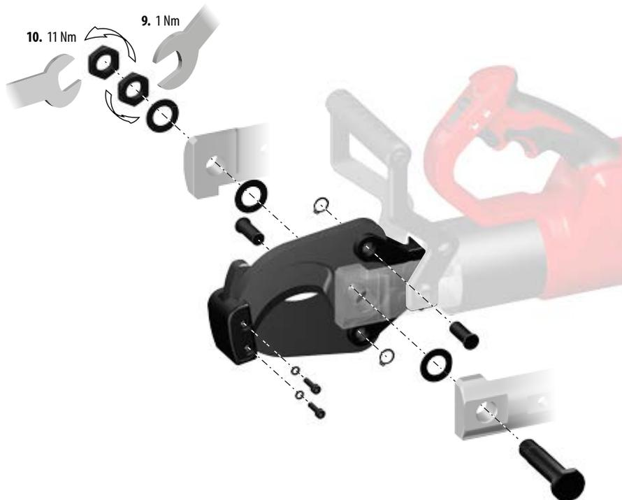
1. Utilizzare una chiave o pinze per rimuovere i dadi della lama e il bullone della lama.
