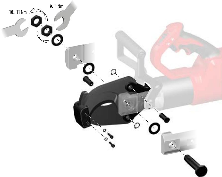
1. Gebruik een moersleutel of een tang om de bevestigingsmoeren te verwijderen en verwijder de bout van het blad.
