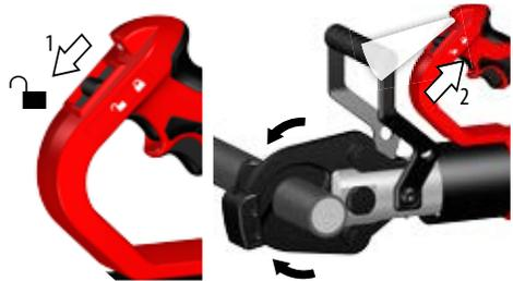
3. Når kuttingen er gjennomført, trekk utløseren for å åpne bladene. (3)
