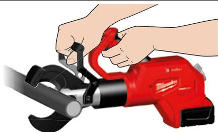
2. Võtke käepideme(te)st tugevalt kinni. Viige liuglülitit lukust avatud asendisse. (1) Tõmmake ja hoidke päästikut kogu kasutamise ajal. (2) Päästiku tõmbamisel süttib LED-lamp. Pärast lõikamist või tööriista väljalülitamist laske päästik lahti.
