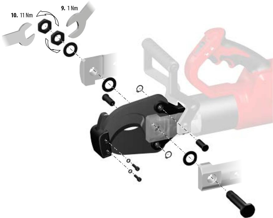
1. Utiliser une clé ou des pinces pour retirer les écrous des lames et retirer le boulon des lames.
