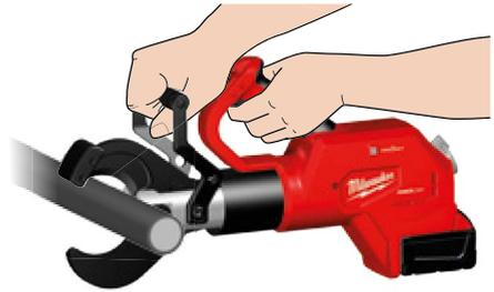
2. Halten Sie das Werkzeug während des Handbetriebs an beiden Griffen fest. Schieben sie den Schaltschieber in die entriegelte Position. (1) Drücken Sie den Auslöser und halten Sie ihn gedrückt. (2) Es schaltet sich eine LED-Leuchtanzeige ein, sobald der Auslöser gedrückt wird. Wenn der Schnitt durchgeführt ist oder das Werkzeug abgeschaltet, lassen Sie den Auslöser wieder los.
