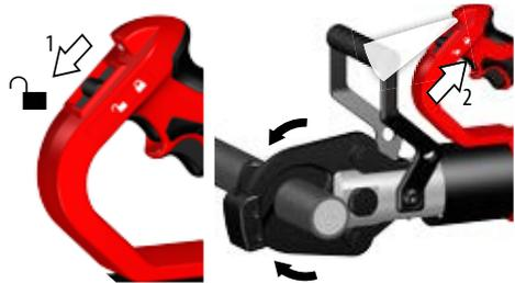
3. Povucite okidač za resetiranje da otvorite oštrice nakon završenog reza. (3)
