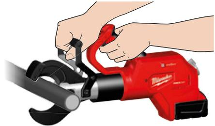
2. Ta et godt grep om håndtaket/håndtakene. Skyv skyvbryteren til ulåst posisjon. (1) Trekk og hold starteren hele tiden under jobben. (2) Et LED-lys vil lyse når starteren trekkes opp. Slipp starteren når kuttet er gjennomført eller til verktøyet slås av.
