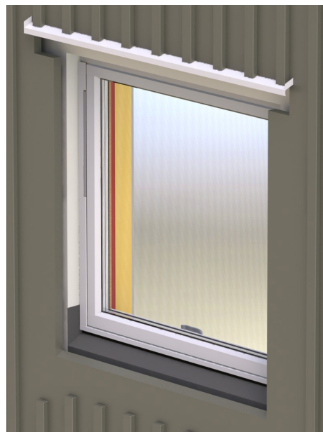
Fig 11. Sekundærtetting rundt hele vinduet. Tettingen hindrer vann for å komme videre inn i vegg.
