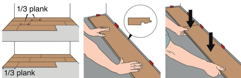
Placera den första plankan i vänstra hörnet av rummet med låslisten i läggningsriktningen. Använd distansklossar för att få ett korrekt expansionsutrymme på 8-10 mm.
