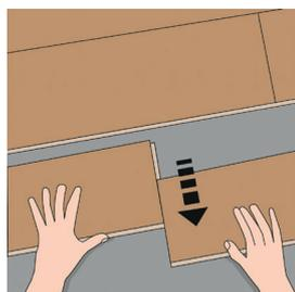
Om du vill demontera ett golv med 5G Loc-systemet, börja med att vinkla upp raden på långsidan. Då lossnar raden och kan nu försiktigt dras ut. Därefter kan du ta isär plankorna genom att skjuta (inte lyfta) dem sidledes på kortsidan.
