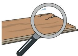
Kontrollera alla plankor i optimala ljusförhållanden, före och under installation, avseende synliga defekter. Defekta plankor ska inte användas, en installerad plank är en godkänd plank. Blanda gärna plankor från olika paket. Detta ger ett golv med ett naturligt utseende.
