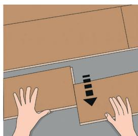
Hvis du vil demontere et gulv med 5G Loc-systemet begynner du med å vinkle opp raden på langsiden. Raden løsner og kan nå forsiktig trekkes ut. Etterpå kan plankene tas fra hverandre ved å skyve (ikke løfte) dem sidelengs ved kortsiden
