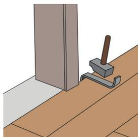
Plankorna har DuoLoc-system på långsidan. Detta innebär att plankorna kan skjutas ihop på långsidan med hjälp av ett slagjärn i situationer där det inte är möjligt att lyfta plankorna för att låsa dem i längdriktningen.
