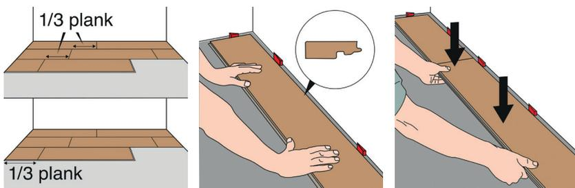
Plasser den første planken i det venstre hjørnet av rommet med låselisten pekende mot leggeretningen. Benytt avstandsklosser for korrekt ekspansjonsavstand på 8-10 mm. Plankene må legges forbandt med en forskyvning av endeskjøtene på min. 1/3 plankelengde.
