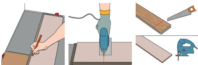
Om du använder handsåg, skär med dekorsidan vänd uppåt. Om du använder en elektrisk sticksåg, skär med dekorsidan vänd nedåt. Ett vasst sågblad är nödvändigt för att få ett bra resultat!
