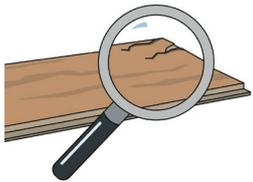
Sjekk alle planker for synlige feil under optimale lysforhold, både før og under installasjonen. Planker med feil må ikke brukes.
