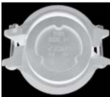
DÅRLIG MONTERING (FEIL SIDE AV ENDELOKKET VENDER UTOVER – FESTENE KAN IKKE STRAMMES FOR Å BRINGE BOLTENES KONTAKTFLATER I METALL-MOT-METALL-KONTAKT)
