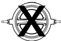
Feil orientering for horisontal installasjon
