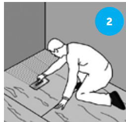
Påfør fleksibelt flislim. Følg leverandørens anbefalinger. 2 (klasse C2/S1 iht. EN 12004/12002).
