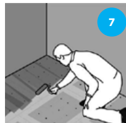
Ferdigsparklet gulv kan nå primes. Følg leverandørens anbefalinger. Belast ikke platene før etter 12 t eller neste dag.
