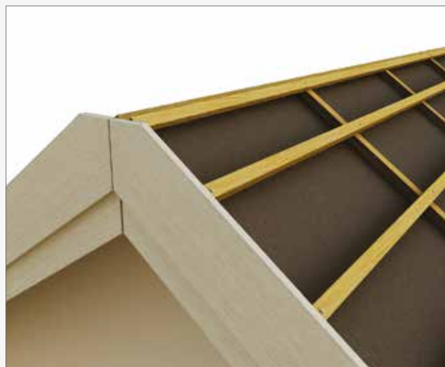
ALTERNATIV 2: Mønekam – Montering uten mønekam, hvis det brukes tettelist møne.
