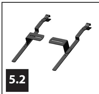
Fest låsebeslag til innfestebøylene med 8x20 mm skruer (5.1/5.2), legg innfestebøylene inn i innfesteskinnen og vri låsebeslaget på plass (5.3). Innfestebøylene må ligge i pannebunnen. Skyv beslagene opp mot lekten og skru fast innfesteskinnen til sperrene med 2 stk 6,5 x 80 mm rustfri, selvborende skruer.
