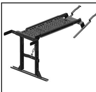
Innfestebøylene skrues til bøyel på plattform med 2 stk 8 x 20 mm sekskantskruer m/mutter.
