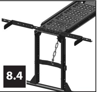
Om skorstensplattformen ska monteras vid sidan av skorstenen måste en sidostötta användas. Ta bort klämmorna från plattformens framkant och fäst dem på sidostöttan. Sidostöttan monteras på skorstensplattformen enligt fig. 6.2.
