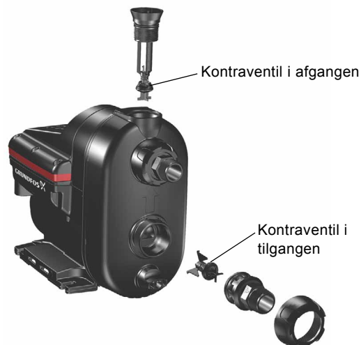
Fig. 20 Kontraventiler på tilgangs- og afgangssiden
