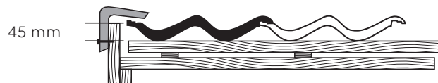
Vindskistein er utformet som en vinkel og beskytter gavlen mot vær og vind.
