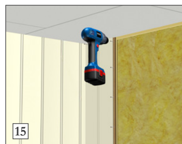
15) Platen skrues i spikerleppen. Inne i hjørnet festes platen synlig. Bunn og topp kan skrues på vanlig måte. Man bruker flikkmalingen (i org.fargen) til å male hodene på de synlige dykkstiftene. Bruk kosten som sitter i korken på flikkmalingsflasken (se bildet under).
