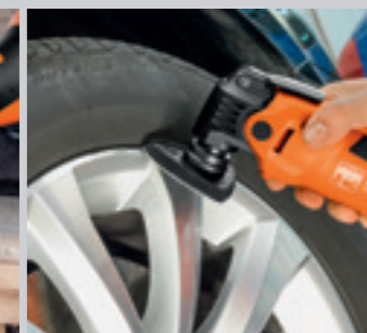
Spesialpapir med svært fine korninger egner seg perfekt til utbedring av lakkeringsfeil og fellområder.
