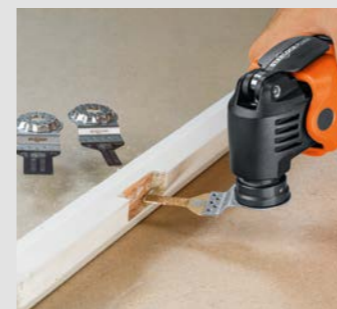
Hardmetallfilen til ren filing av riller, notspor, åpninger og falser.
