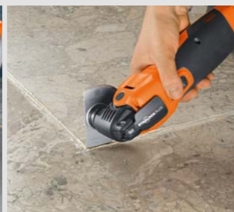
Suverent stor slitestyrke med diamantverktøy.
