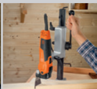
Kan kombineres med et bordstativ for millimeternøyaktig arbeid.
