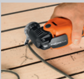
Bruk natekniven for en tidsbesparelse på opptil 80 % ved fornyelse av teakdekk med nater.
