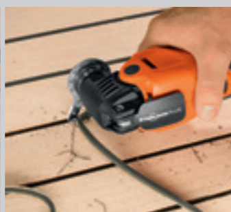
Bruk natekniven for en tidsbesparelse på opptil 80 % ved fornyelse av teakdekk med nater.
