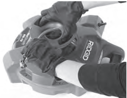
Figura 7 C – El cable se alimenta a través del agujero destapado
