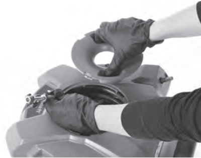
Figura 7 B – Se retiran del tambor el cable y la golpeadora de cadenas
