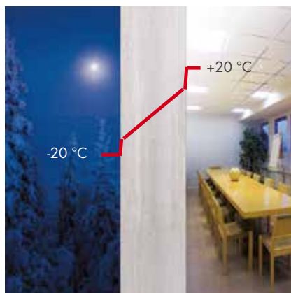
Utvendig isolering holder den bærende veggen varm, og den vil derfor inneholde mindre fukt. Utvendig isolering gir også høyere temperatur på den innvendige veggens overflate.
