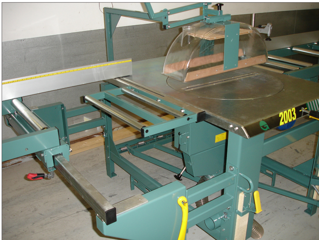
Fig. 3 - Montering av venstre rullebord
