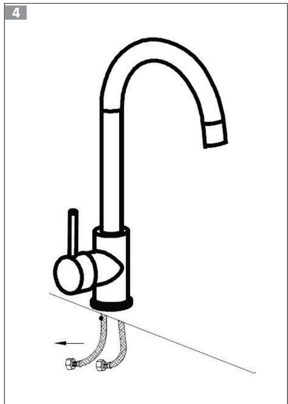
Koble slangene for varmt-/kaldtvann til vanttøforselen, og trekk godt til.
