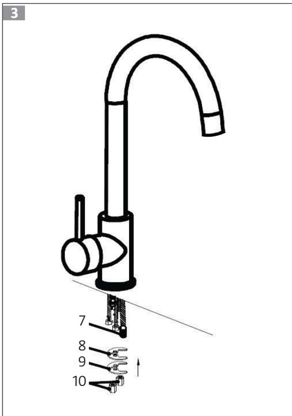
Før slanger og stag gjennom benkeplaten og monter pakning (8), hestesko (9) og muttere (10).
