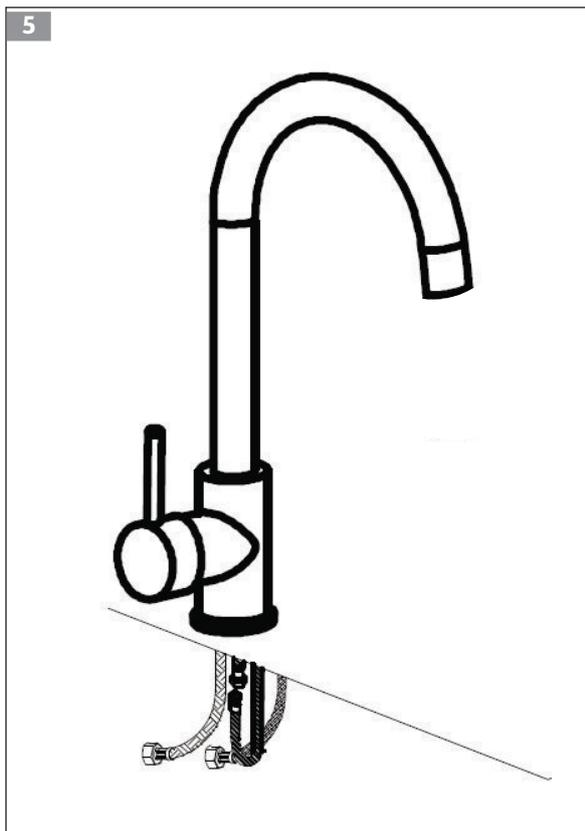
Koble den siste fleksible slangen sammen med den uttrekkbare slangen, og stram godt til.
