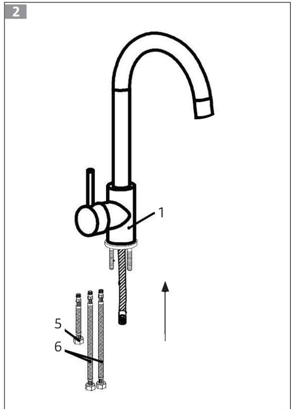
Monter de fleksible slangene for varmt- og kaldtvann samt den uttrekkbare slangen på kroppen.
