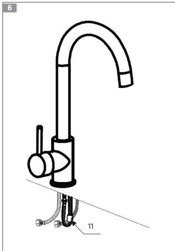
Monter loddet(11) på den uttrekkbare slangen, og selve monteringen er ferdig.
