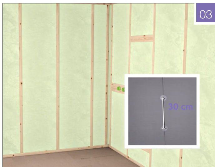
Fig. 03: Fest deretter flere Jackon Våtromsskruer og Festeskiver i hver plateskjøt, med en avstand c/c 30cm.
