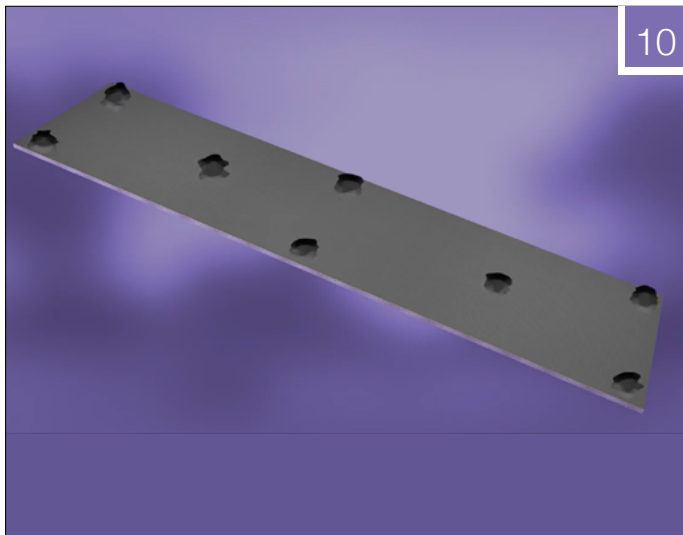
Fig. 10: Stikk 8 hull i platen med et skrujern, påfør deretter flislim i festepunktene. Sett platen mot veggen og la disse herde til neste dag.
