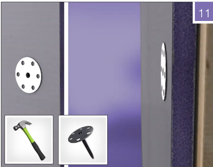
Fig. 11: Bor så 8mm hull med murbor gjennom senter av limpunktene. Slå inn ståldybler som er minimum 50mm lengre enn platens tykkelse.
