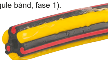
Produktet i svellet tilstand etter kontakt med vann (gule bånd, fase 1).
