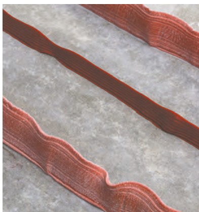
Produkt i normal og i svellet tilstand etter kontakt med vann.
