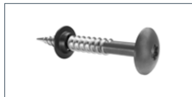
Cembrit Fasadeskrue til tre Med sentreringspakning SCR-W 4.5x40mm A4 rustfritt stål
