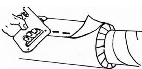
5. GLAVA® Lamellmatte skal før taping festes mekanisk med stifter i langsgående skjøter.
